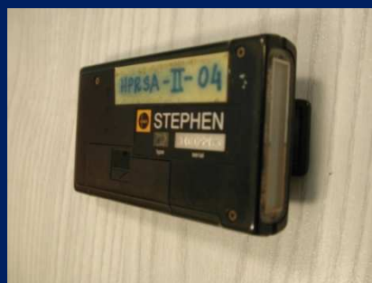
Typowe przyrządy dozymetryczne produkcji Polskiej (gamma,X, alfa, beta)
