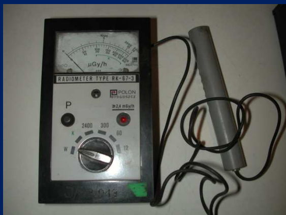
Typowe przyrządy dozymetryczne produkcji Polskiej (gamma,X, alfa, beta)
