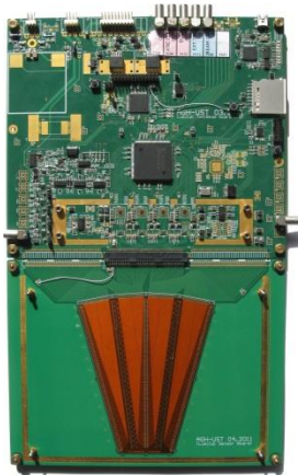
Jeden sektor detektora krzemowego z prototypową elektroniką odczytu.
