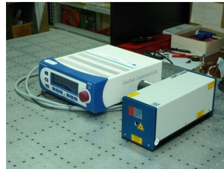
Przestrzalny laser 780 nm (+10 nm) oraz prototypowy układ testowy.
